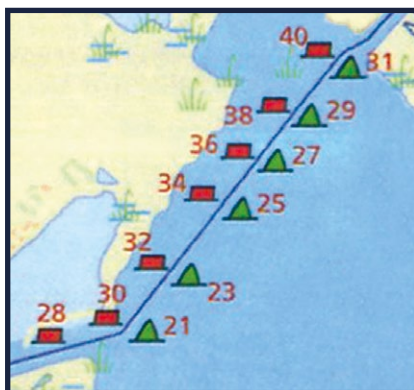
plavební dráha s čísly plavebních bójí, nemusíte se jí držet, mimo ni však vždy hlídejte hloubku
