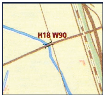
pevný most s výškou (H), nedostatečnou pro průjezd vaší lodě – otočte loď a vyhledejte náhradní plavební trasu – šířkou (W); všechny údaje jsou uvedeny v decimetrech
