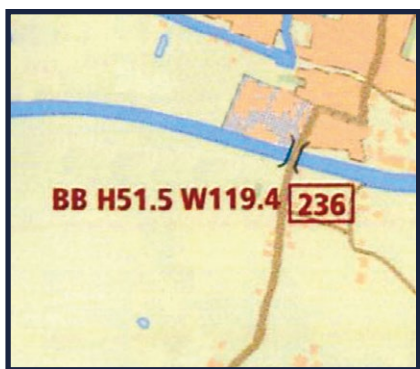
zvedací most (BB) s výškou (H), dostatečnou pro průjezd vaší lodě, projíždíte při zavřeném mostu (více viz kapitola jak projíždět mosty), a šířkou (W); všechny údaje jsou uvedeny v decimetrech
