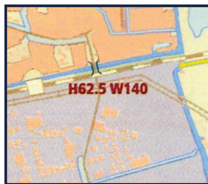
pevný most s výškou (H), dostatečnou pro průjezd vaší lodě (více viz kapitola jak projíždět mosty), a šířkou (W), všechny údaje jsou uvedeny v decimetrech
